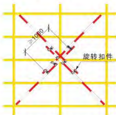
剪刀撑搭设方法示意
